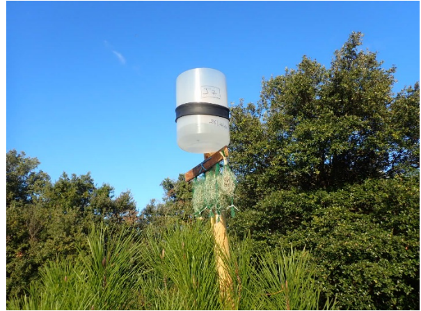
Illustration 2 : Pluviomètre installé sur les halles supérieures de la verse
